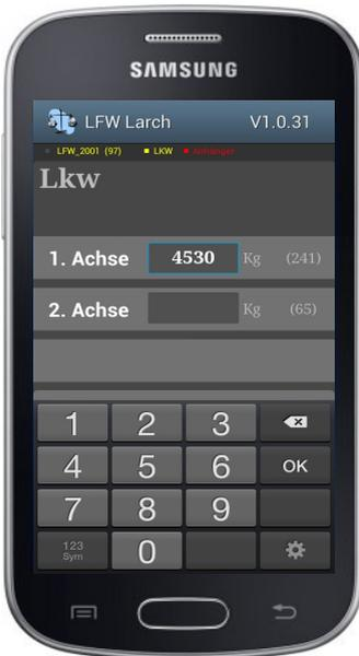
Nun kann für jede Achse das Gewicht in Kg eingegeben werden. Nach Betätigung der Taste *Weiter* wird das Gewicht dieser Achse in den Speicher übertragen. Es kann jede Achse einzeln und in beliebiger Reihenfolge abgeglichen werden.
